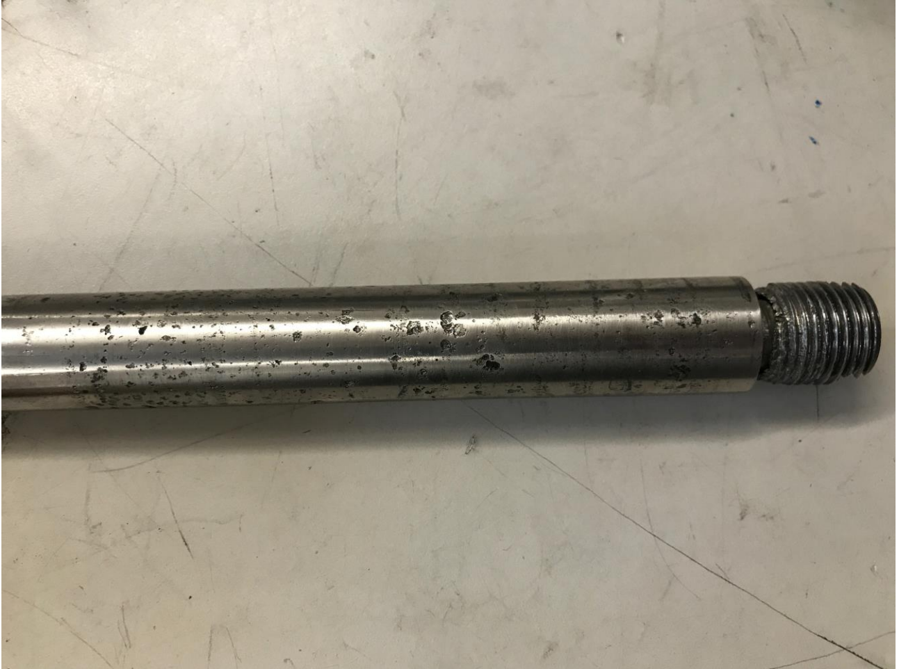
Widoczne uszkodzenia trzpienia zaworu.
