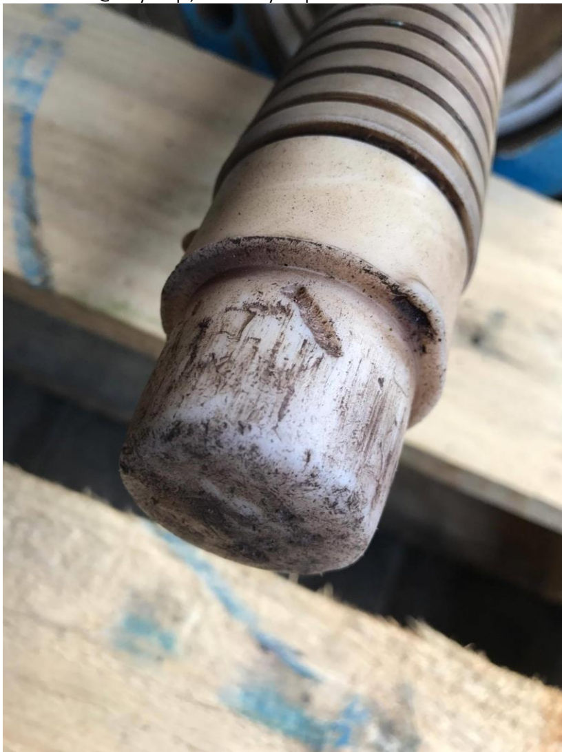
Widoczne uszkodzenia grzyba zaworu
