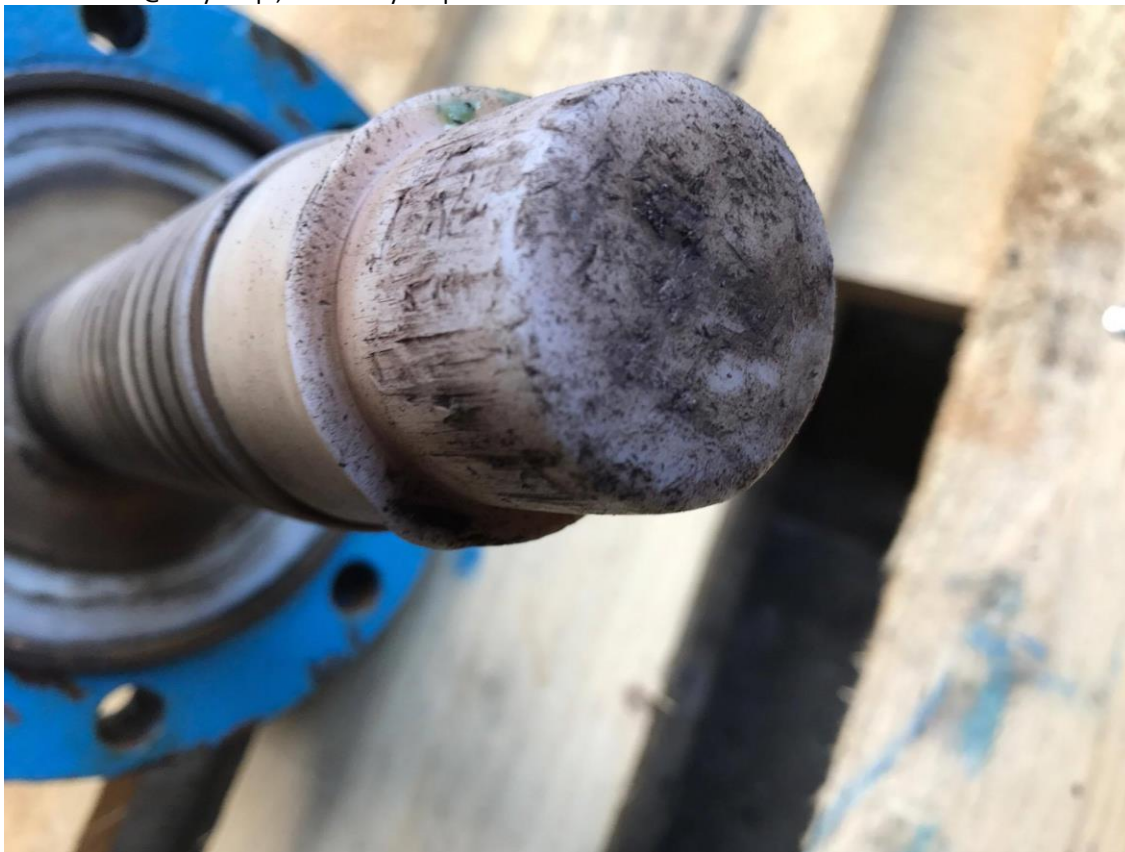
Widoczne uszkodzenia grzyba zaworu
