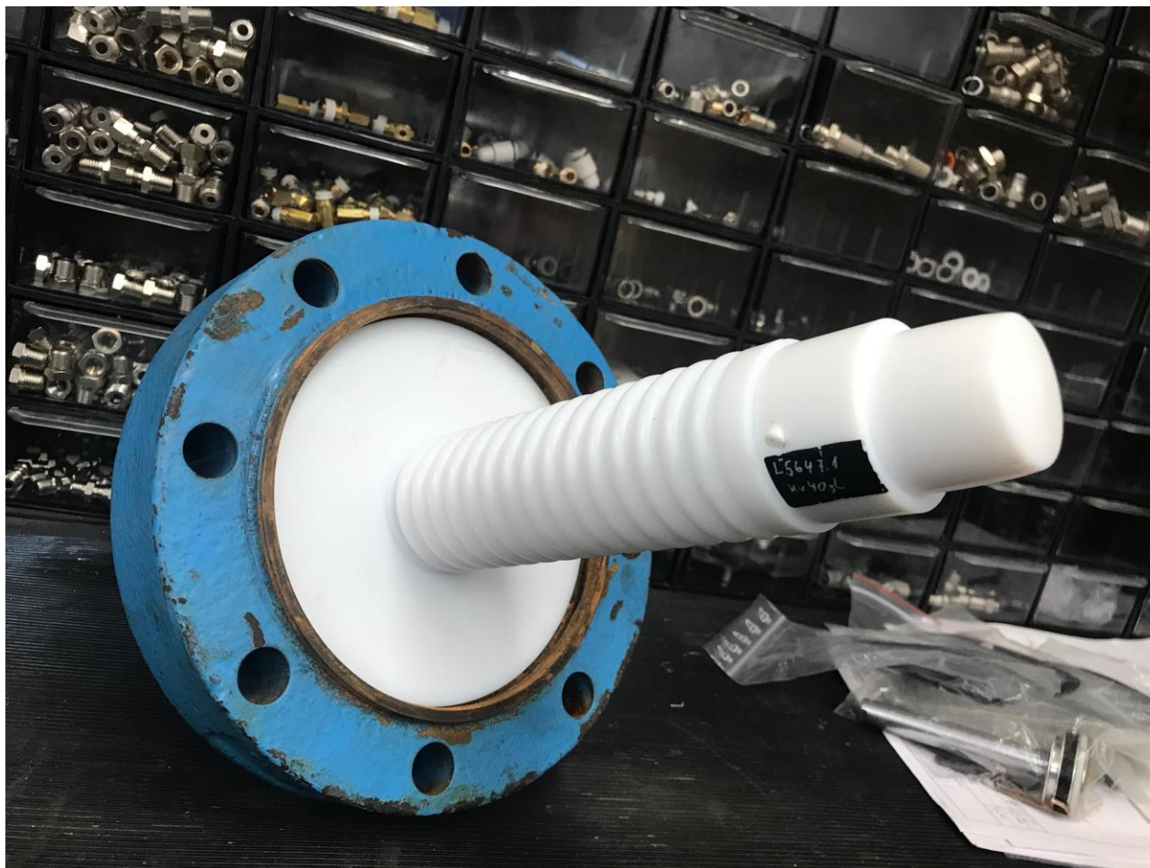
Grzyb wraz z dławicą mieszkową po wymianie.
